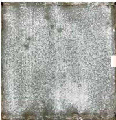
▲モルタルへ散布後外観—透明被膜を形成し自然な風合い
