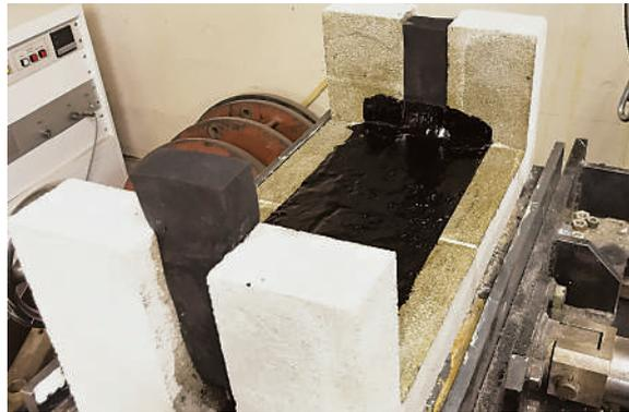
6000回伸縮試験後漏水なし
