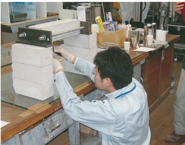
▲プライマーひび割れ含浸状況 (0.2mm以下のひび割れに40mm以上浸透)
