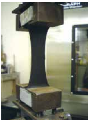
◀接着試験(1600%伸張状況) 被着体:コンクリート 養生条件:23℃・24h
