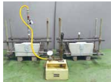
▲耐水圧試験状況写真
