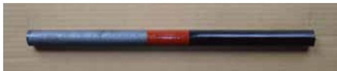
コンクリートの膨張・収縮の移動量を吸収する為に一方の先端にスリップキャップ(材質:プラスチック)を被せます。
