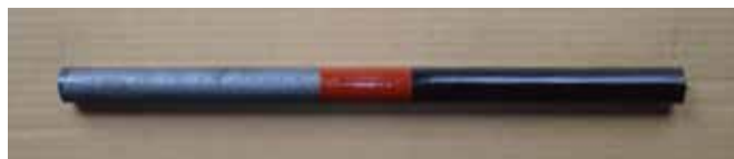
ダウエルバーとスリップキャップの組み合わせ及び寸法
