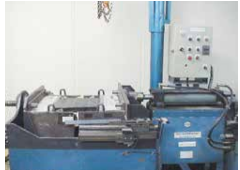
▲伸縮耐久試験状況
