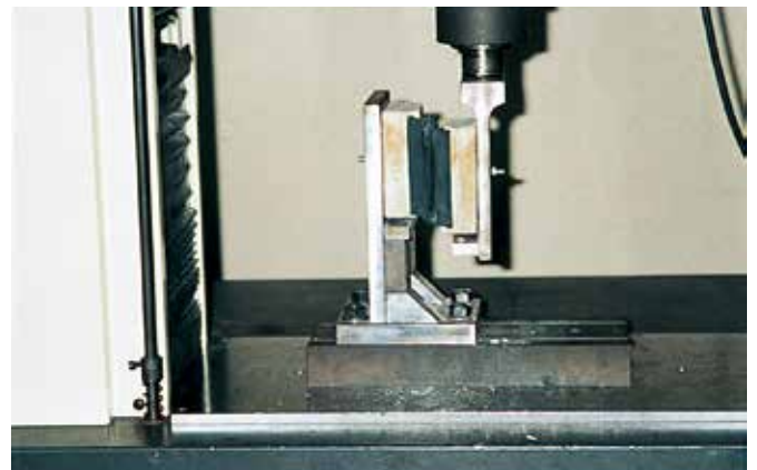
▲水平せん断試験状況
