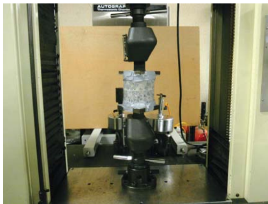
▲打継接着性試験状況
