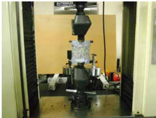
▲打継接着性試験状況
