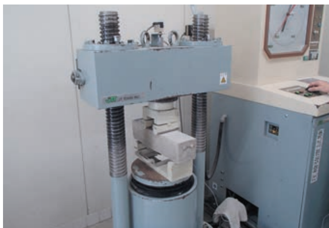
▲曲げ載荷試験状況
