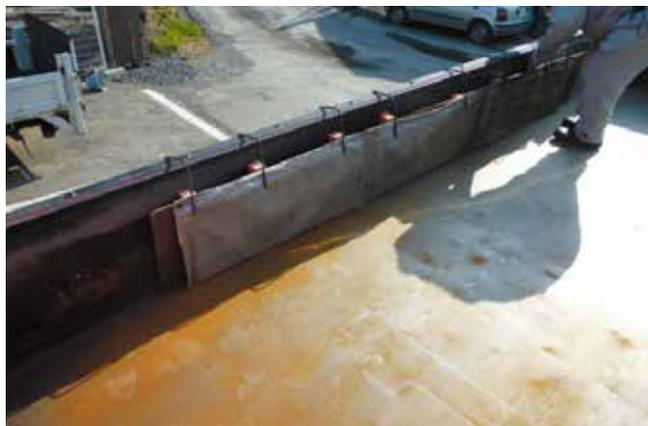
▲ベニヤ板・コの字鉄筋等を用い荷台側面に取付けます。
