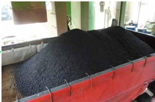
▲側面タイプ設置後、アスファルト混合物を積載します。
