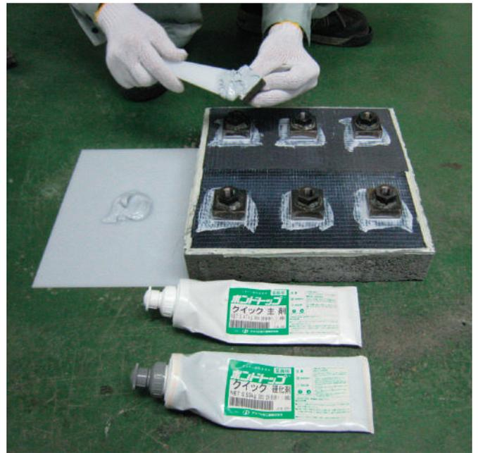
▲試験用治具への接着に使用
